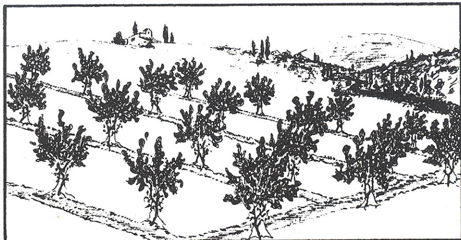
Fig. 7 - Prospetto schematico della rete fognaria di un coltivo arborato con fosse di scolo ortogonali ad un capofosso collettore.
