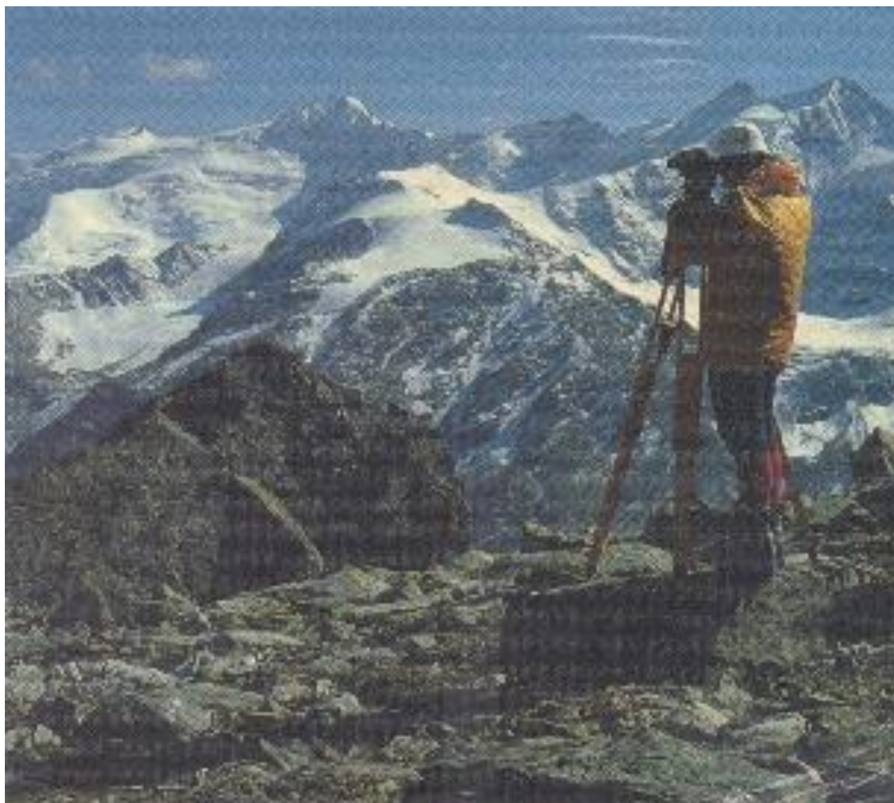
Fig. 1 Misura di variazione frontale tramite l'utilizzo del teodolite.
