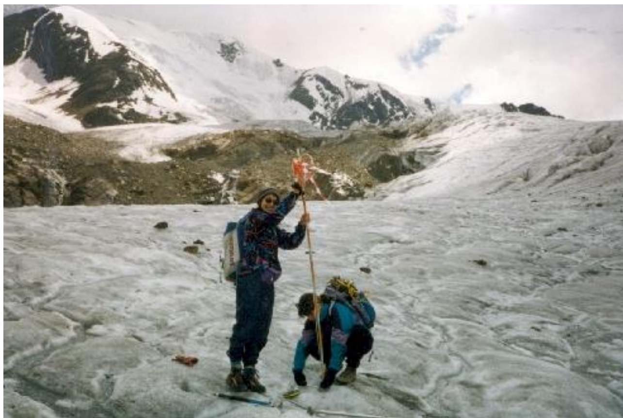
Fig. 2 Misurazione di una palina ablatometrica, utilizzata per il calcolo del bilancio di massa del ghiacciaio.
