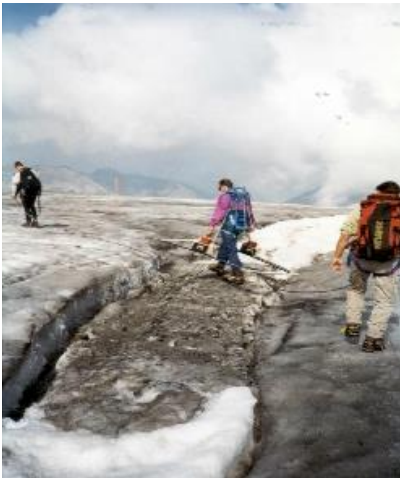
Fig. 4 Esecuzione di sondaggi georadar su di un apparato glaciale.
