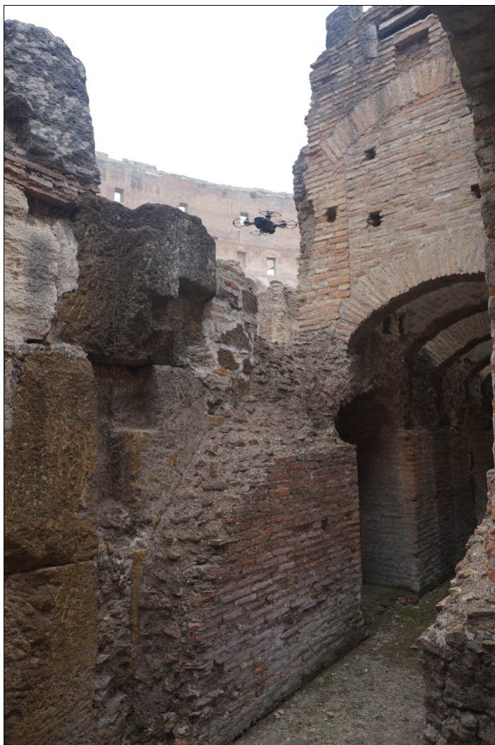
Figura 3. Drone FTD Spark del GREAL durante l'acquisizione fotogrammetrica delle strutture ipogee dell'arena del Colosseo (ottobre 2017)
