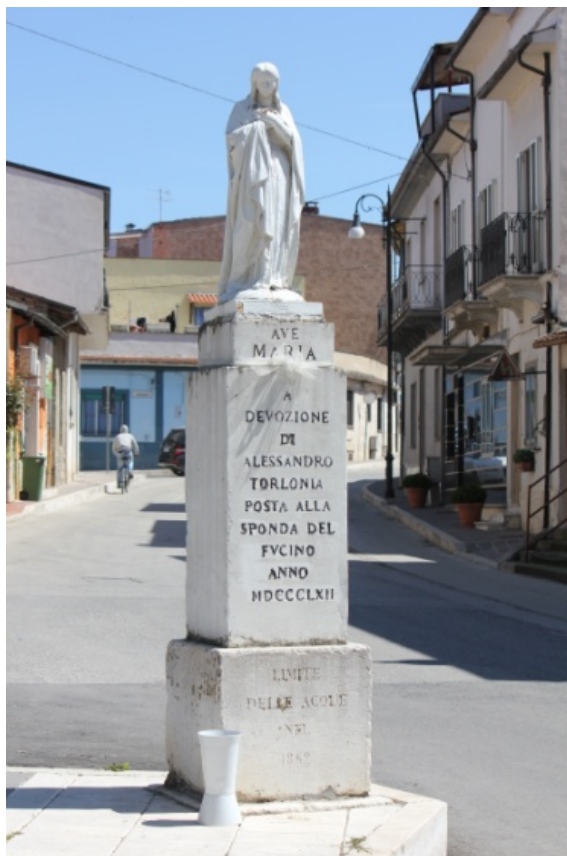
Figura 5. Una delle statue votive poste a limite del lago del Fucino nel 1862 oggi nel centro dell'abitato di San Benedetto dei Marsi. Si tratta del caposaldo n. 6 di Loperfido (vedi fig. 6) che, in base ai suoi calcoli, ha subito un abbassamento di 0,329 m
