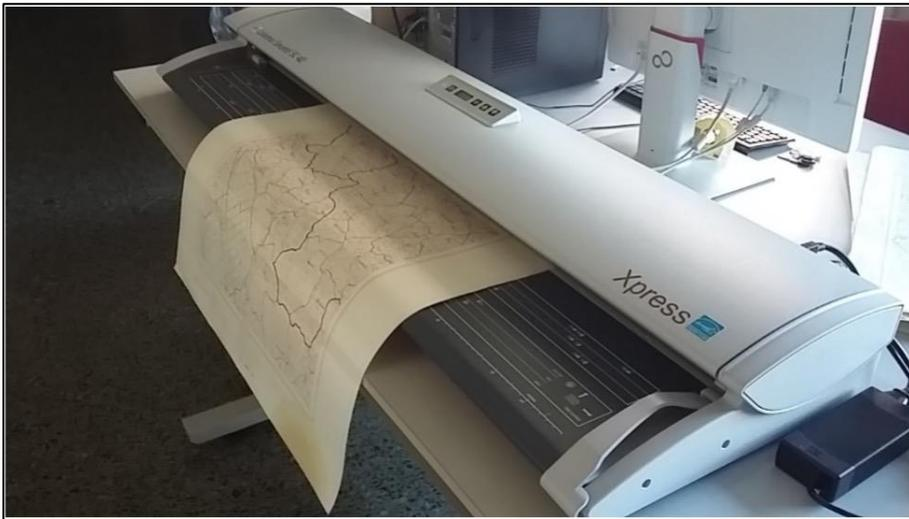
Figura 1. Attività di digitalizzazione con lo scanner a rullo Colortrac SmartLF SC 42 Xpress formato A0. (Fonte: fotografia dell'Autrice).
