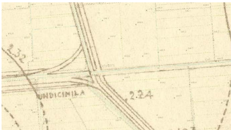
Figura 8. Sovrapposizione della CTR Abruzzo e della scansione del piano quotato rilevato nel 1915. Si osserva lo scostamento dei manufatti nei due elaborati
