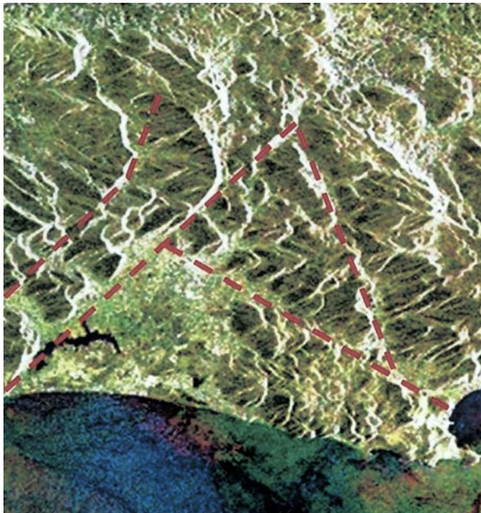
Figura 3. Stralcio modificato dell'immagine multitemporale areale dell'assetto della Piana di Fondi; evidenziati con il tratteggiato i principali lineamenti strutturali dell'area (ESA-ESRIN - 1995, per gentile concessione)
