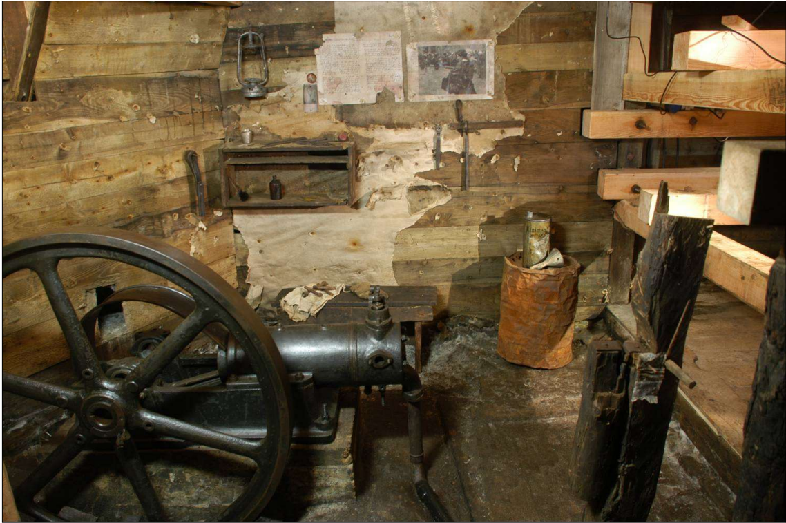
Figura 6. Punta Linke. Il motore di trazione della teleferica riposizionato all'interno della baracca
