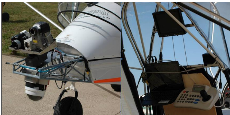
Figura 4. UFL configurazione B (c.d. “Ricognizione Emergenze”). Sulla piattaforma superiore, allargata, sono installati, da sinistra a destra: fotocamera reflex, videocamera ad alta risoluzione, termocamera. Sull’attacco inferiore è installata una “dome”-camera video ad alta risoluzione. L’operatore di sistema gestisce fotocamera e termocamera mediante il computer (a sinistra nell’abitacolo posteriore) e le videocamere da consolle e monitor. I segnali delle videocamere e il segnale video della termocamera sono “salvati” su un videoregistratore con hard-disk (non visibile nelle immagini). Tutti i dati possono essere trasmessi a terra
