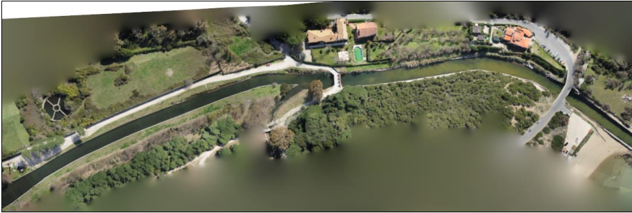
Figura 17. Modello fotogrammetrico tridimensionale del Porto Canale romano di Paola, presso il Promontorio del Circeo, ricavato da volo UFL, con l'ausilio di una rete di punti di controllo a terra ( software ImageMasterPhoto™ e Agisoft Photoscan™. Elaborazione Diego Ronchi)
