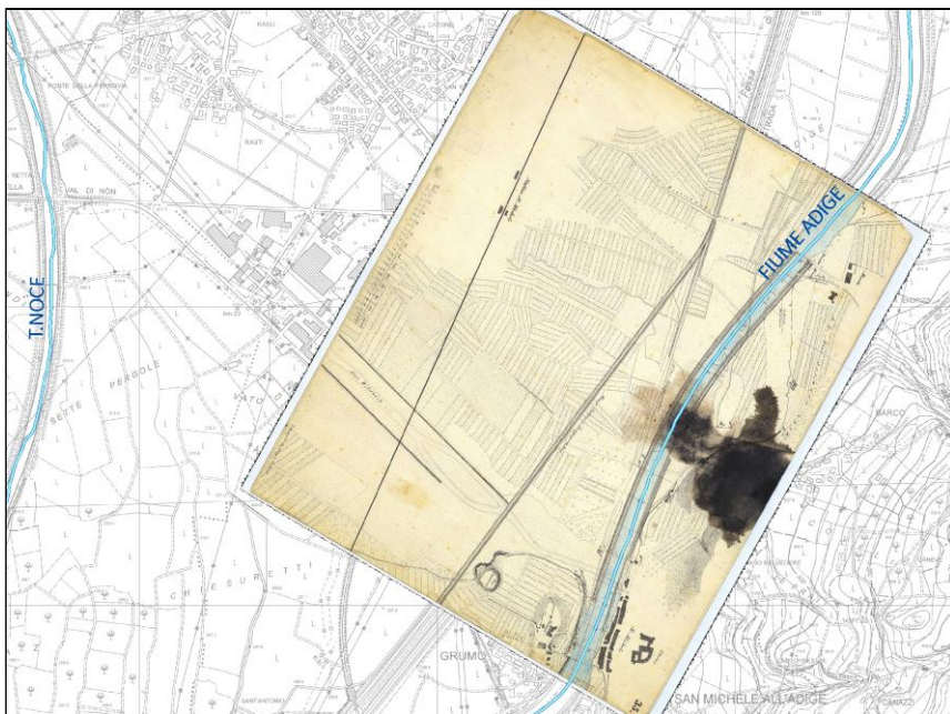
Figura 3. Rettificazione geometrica della Claricini-Karte , foglio-mappa 35: trasformazione globale affine a 6 parametri
