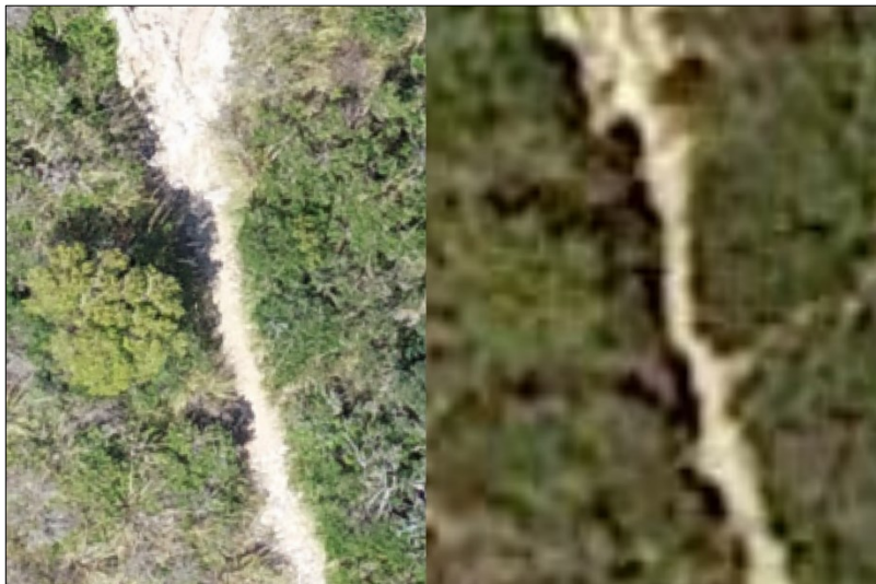
Figura 6. Confronto nel livello di dettaglio di rappresentazione di un tratto di sentiero come visualizzato nell'ortofoto da drone (a sinistra) e nell'immagine satellitare visibile su Google Earth (a destra)
